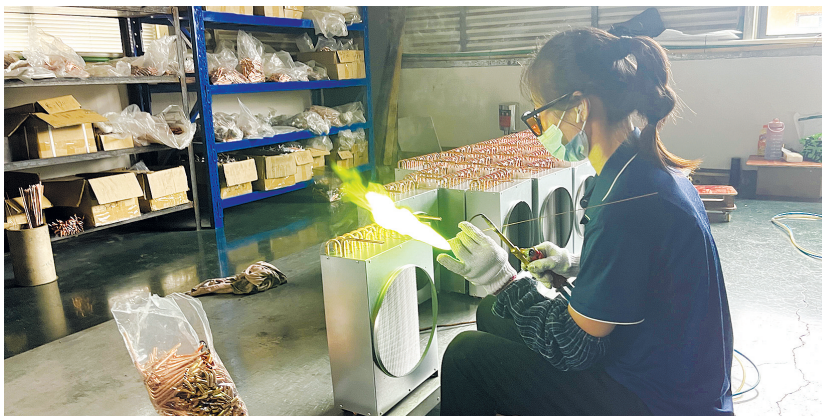
女焊工正在焊接翅片冷凝器。 记者 吴建邦 摄
